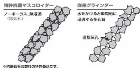
図4 グラインダーの断面図
